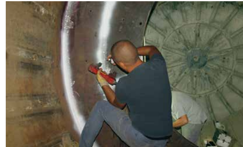
Controllo strutturale della parte interna del mulino con liquidi penetranti ed ultrasuoni.
