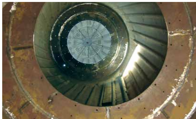
Saldatura accurata dei settori che compongono l'anello.
