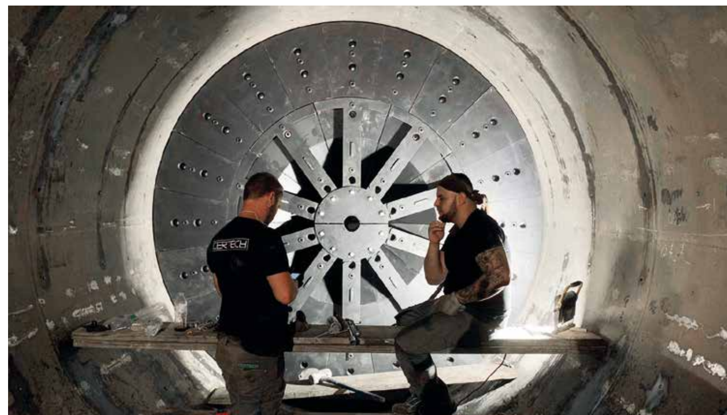
Testata d'uscita mulino 100.000 lt. Discharge end head 100.000 Lts mill. Cabezal de descarga molino 100.000 Lts. Tête de déchargement broyeur 100.000 Lt .
