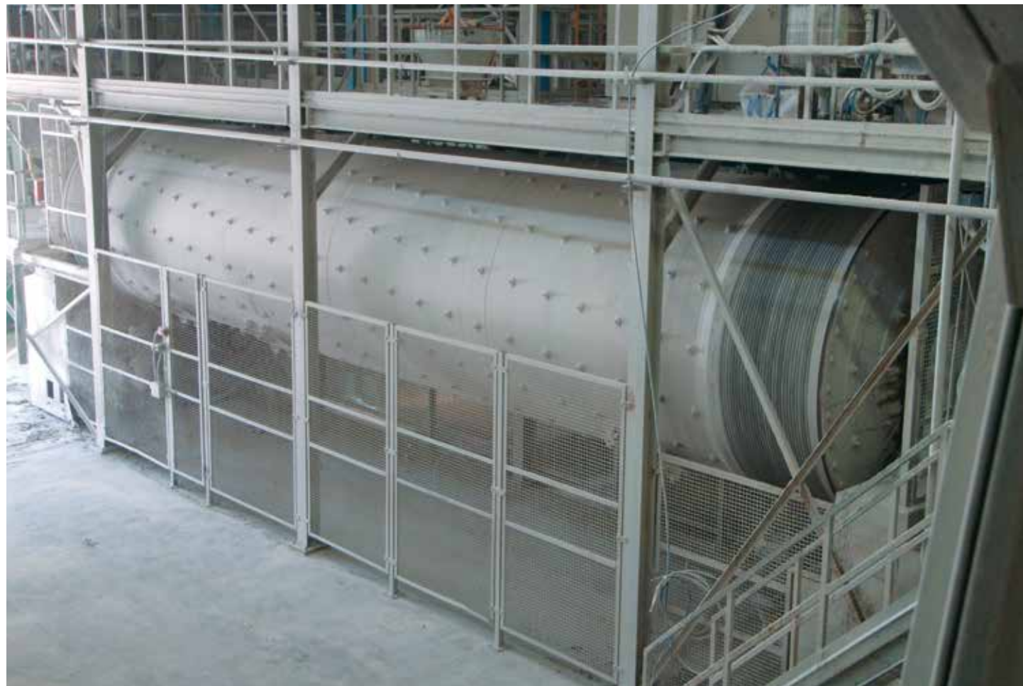
Mulino continuo classificante con capacità di 60.000 litri. Continuous sorting mill with a capacity of 60,000 litres. Molino continuo clasificante con capacidad de 60.000 litros. Moulin continu de classification doté d'une capacité de 60 000 litres.
