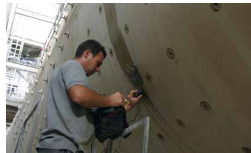
Controllo strutturale del cilindro del mulino con ultrasuoni.
