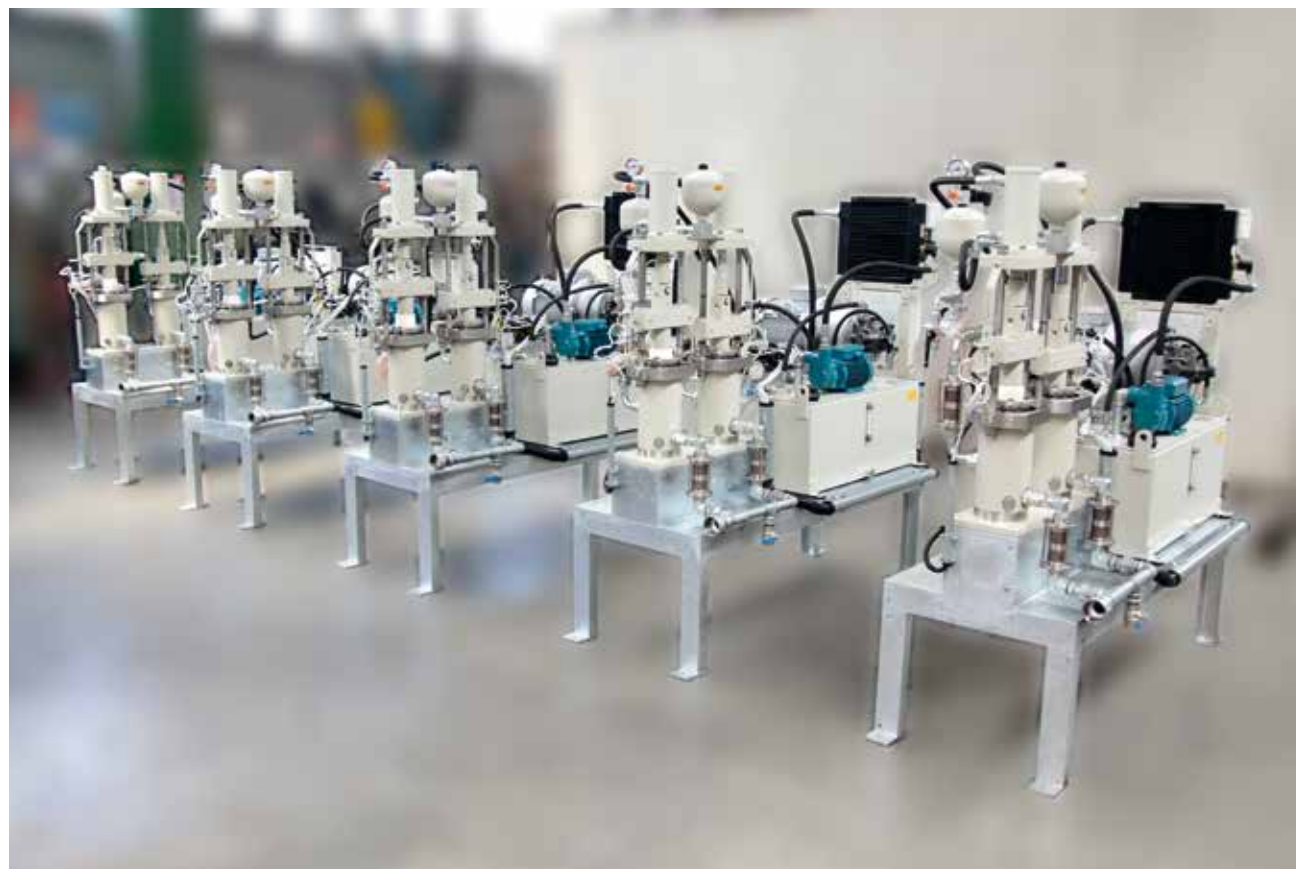
Nr. 5 Pompe tipo PT 80 assemblate e collaudate presso il nostro stabilimento. Nr.5 PT80 pumps assembled and tested by our factory. Nr.5 bombas tipo PT 80 ensambladas y probadas en nuestra fábrica. Nr.5 Pompes type PT 80 assemblées et essayées à notre établissement.
