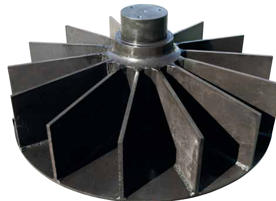
Mozzo per mulino discontinuo completo di raggiera. Saldato, con ricottura di distensione e bonifica. Hub for discontinuous mill, complete with spoke wheel. Welded, with relieving annealing and regeneration. Eje para molino discontinuo con corona. Soldado, con recocción de distensión y regeneracion. Moyeu pour broyeur discontinu avec rayons. Soudé, avec recuit de détente et de régénération.
