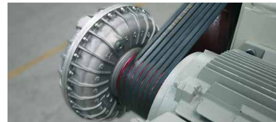
Dettaglio rinvio e giunto idraulico. Detail of transmission and hydraulic coupling. Detalle reenvío y junta hidráulica. Détail renvoi et joint hydraulique.
