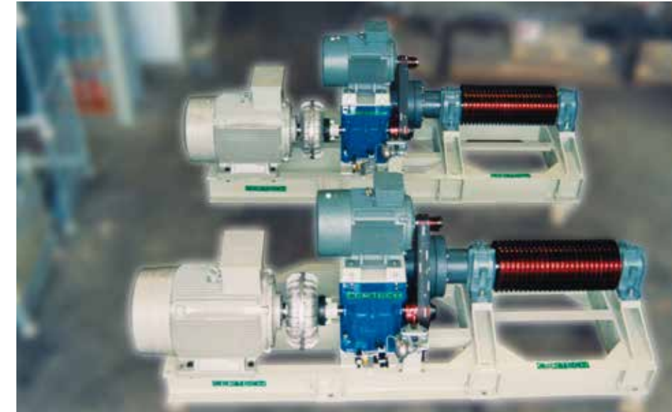
Batteria di nr. 2 motorizzazioni per mulini da 38.000 litri. Set of 2 motorizations units for 38,000 litre mills. Batería de 2 motorizaciones para molinos de 38.000 litros. Batterie de 2 motorisations pour moulins de 38.000 litres.
