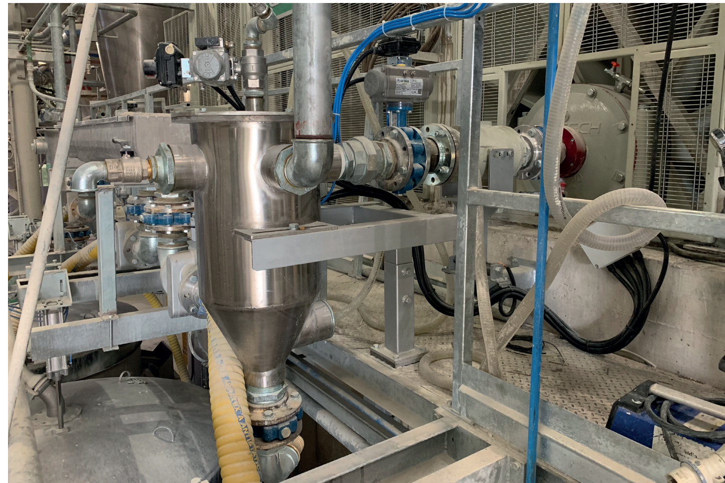
Dettaglio zona di scarico barbottina su mulino raffinatore. Detail slip discharging area on refiner mill. Detalle de la zona de descarga barbotina en el molino refinador. Détail de la zone de déchargement des barbotines sur le broyeur raffineur. Detalle de la zona de descarga barbotina en el molino refinador.
