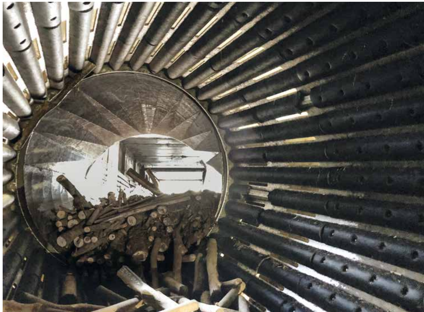
Vista interna mulino per la scortecciatura di tronchi in legno. Inside view of wooden logs debarking mill. Vista interior molino para descortezado troncos de madera. Vue de l'intérieur broyeur pour écorçage grumes en bois.
