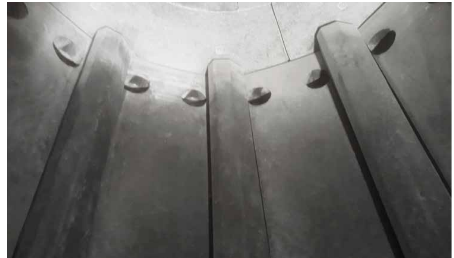
Piastre forate per scarico materiale su mulino per macinazione a secco. Discharge drilled plates on dry grinding mill. Placas perforadas para descarga sobre molino para molienda a seco. Plaques trouées pour déchargement dans broyeur pour broyage à sèche.
